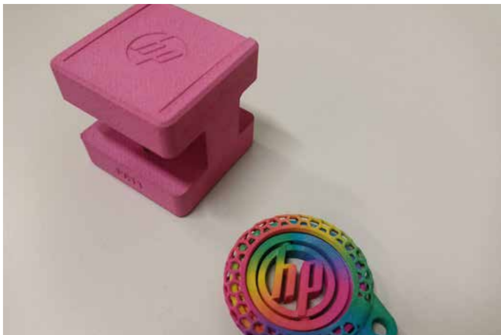
4. Przykłady wydruków, wykonanych technologią MJF: barwionego metodą zanurzeniową (różowy) oraz wykonanego na maszynie HP 580 COLOR. Źródło: J. Trzyna Examples of prints made with MJF technology: dye dipped (pink) and made on the HP 580 COLOR machine. Source: J. Trzyna
