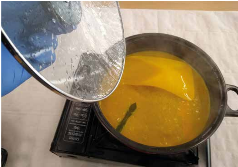
3. Barwienie zanurzeniowe wydruków, wykonanych technologią SLS. Źródło: J. Trzyna Immersion dyeing of prints made with SLS technology. Source: J. Trzyna
