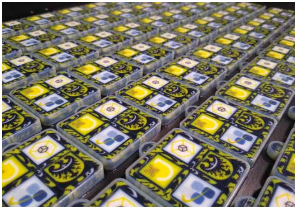
5b. Technologia PolyJet: Realizacja kolorowych wydruków 3D na bazie cyfrowych modeli. Źródło: J. Trzyna PolyJet technology: Realization of color 3D prints based on digital models. Source: J. Trzyna
