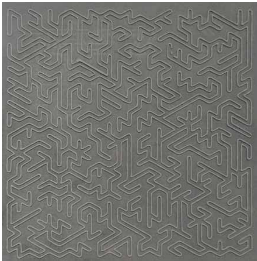
MEANDER fragment (2, -95°), 2022 technologia SkribiArt - głowica GAJA beton architektoniczny, 100×100 cm MEANDER fragment (2, -95°), 2022 SkribiArt technology - GAJA printer head architectural concrete, 100×100 cm
