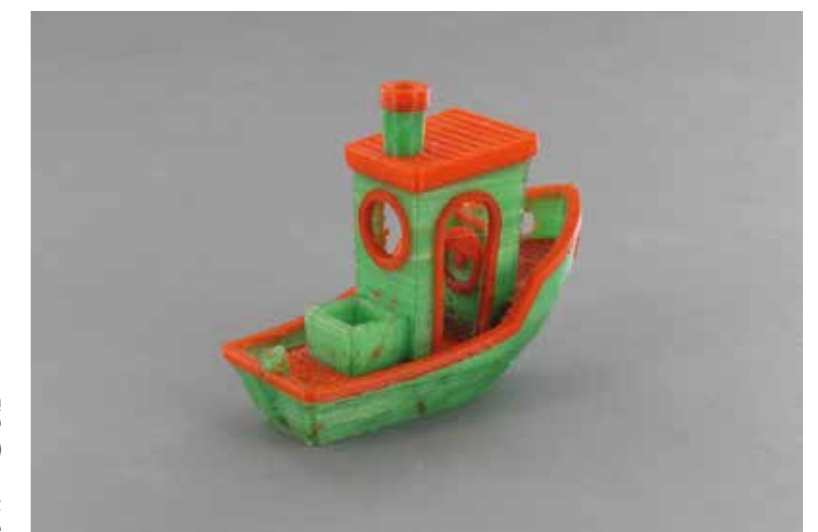
2c. Dwukolorowy wydruk 3Dbenchy, wykonany dwugłowicową drukarką. Źródło: https://www.flickr.com/photos/132390309@N03/19853228512 , autor: 3DBenchy, na licencji CC BY 2.0 Two-color 3DBenchy print made with a two-head printer. Photo: https://www.flickr.com/photos/132390309@N03/19853228512 by 3DBenchy under CC BY 2.0 license
