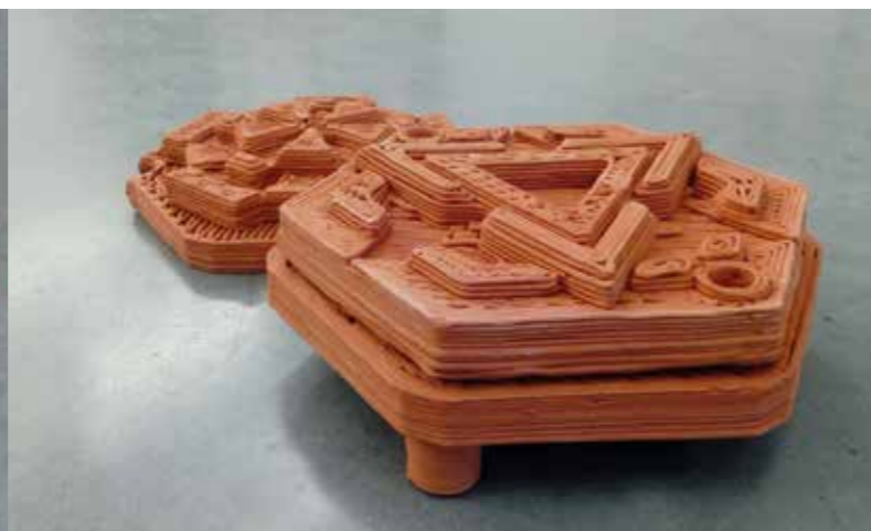
11b. Ceramiczne, drukowane w 3D, płytki podstrukturalne rafy. Źródło: F. Kolaiti Ceramic 3D printed substructural reef tiles. Source: F. Kolaiti
