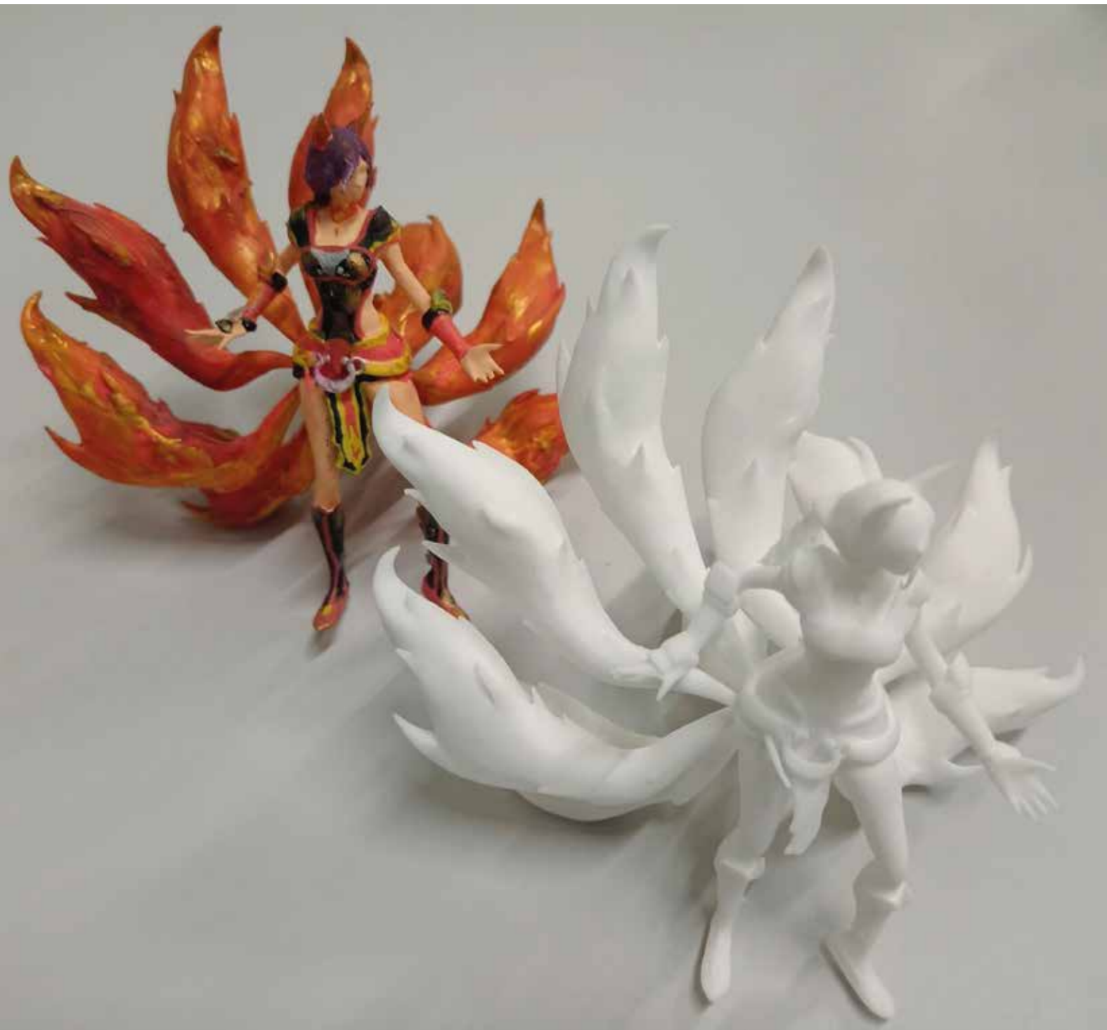
1. Surowy biały wydruk, wykonany technologią SLS, oraz wydruk po ręcznym barwieniu modelu. Źródło: J. Trzyna A raw white printout, made with SLS technology and a printout after hand-dyeing the model. Source: J. Trzyna
