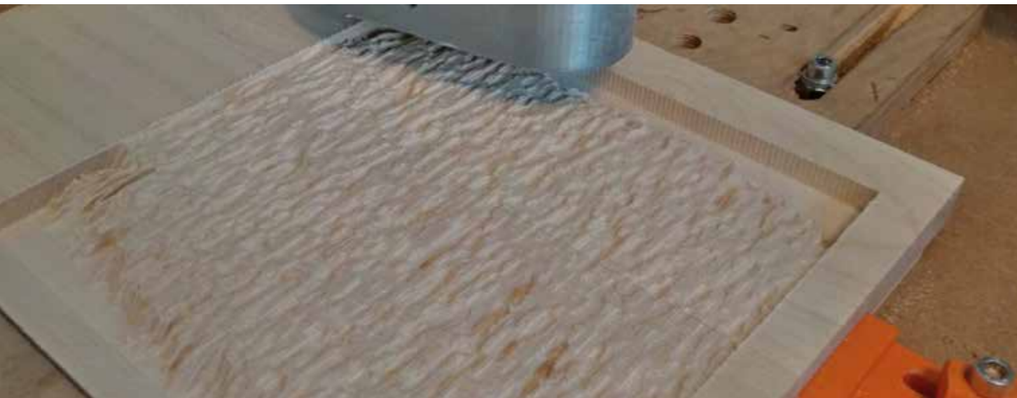
10. Obróbka matrycy na ploterze CNC. Źródło: M. Noga Machining the die on a CNC router. Source: M. Noga
