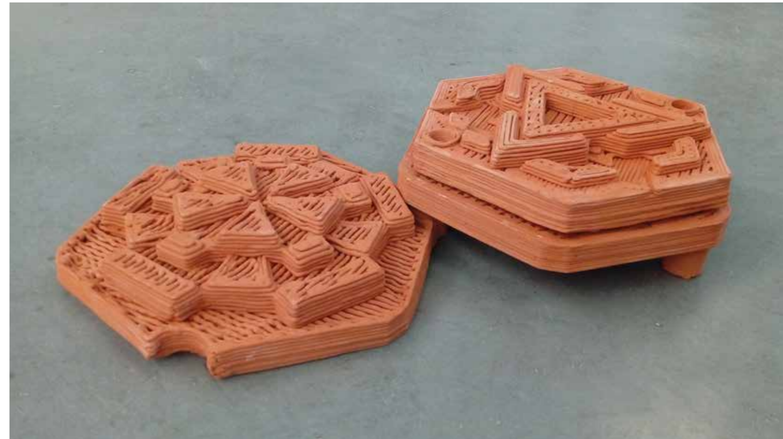
11c. Ceramiczne, drukowane w 3D, płytki podstrukturalne rafy. Źródło: F. Kolaiti. Ceramic 3D printed substructural reef tiles. Source: F. Kolaiti.
