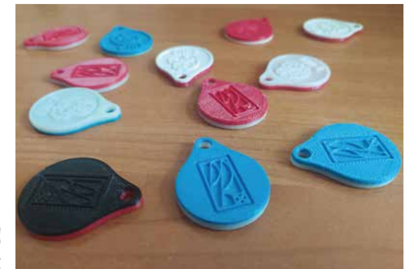
2b. Dwukolorowe breloczki, wykonane metodą ręcznej zmiany filamentu. Źródło: J. Trzyna Two-color keychains made with manual filament change. Source: J. Trzyna
