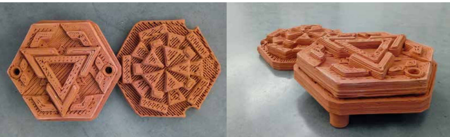
11a. Ceramiczne, drukowane w 3D, płytki podstrukturalne rafy. Źródło: F. Kolaiti Ceramic 3D printed substructural reef tiles. Source: F. Kolaiti
