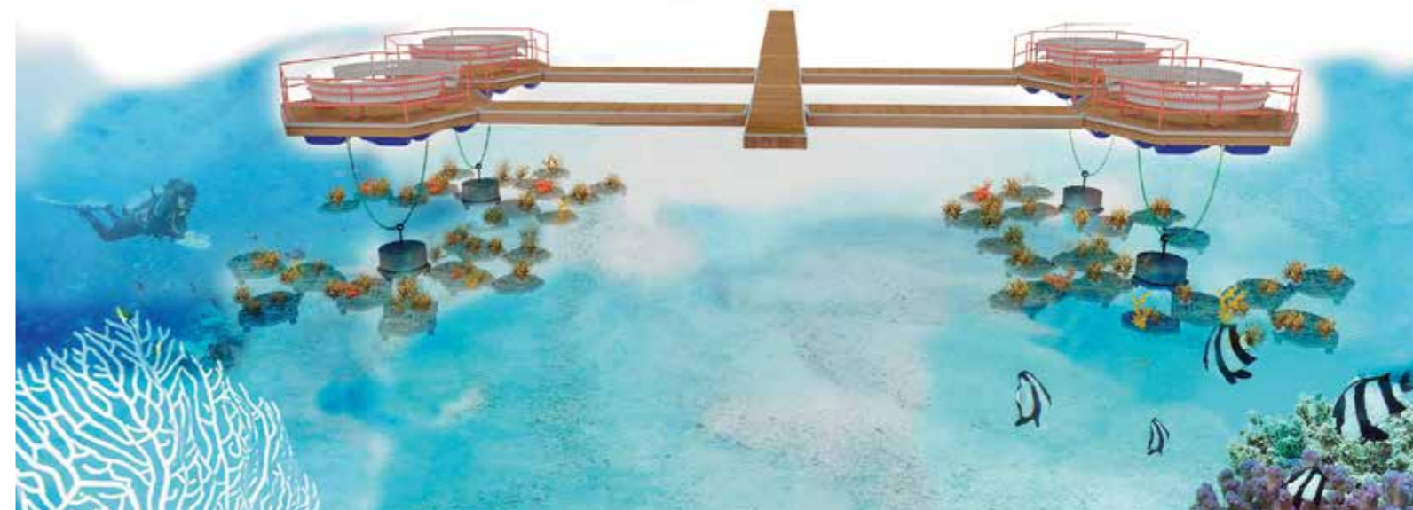
9. Renderowane ławki na pływającym doku z podstrukturalnymi, drukowanymi w 3D ceramicznymi płytkami rafowymi. Źródło: F. Kolaiti Rendered benches on floating dock with substructural 3D printed ceramic reef tiles. Source: F. Kolaiti
